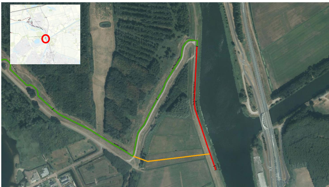
Figuur 14 Bovenaanzicht deelgebied Haagse Beemden met in oranje de locatie voor de dijkverlegging en in rood het afgekeurde dijktracé
