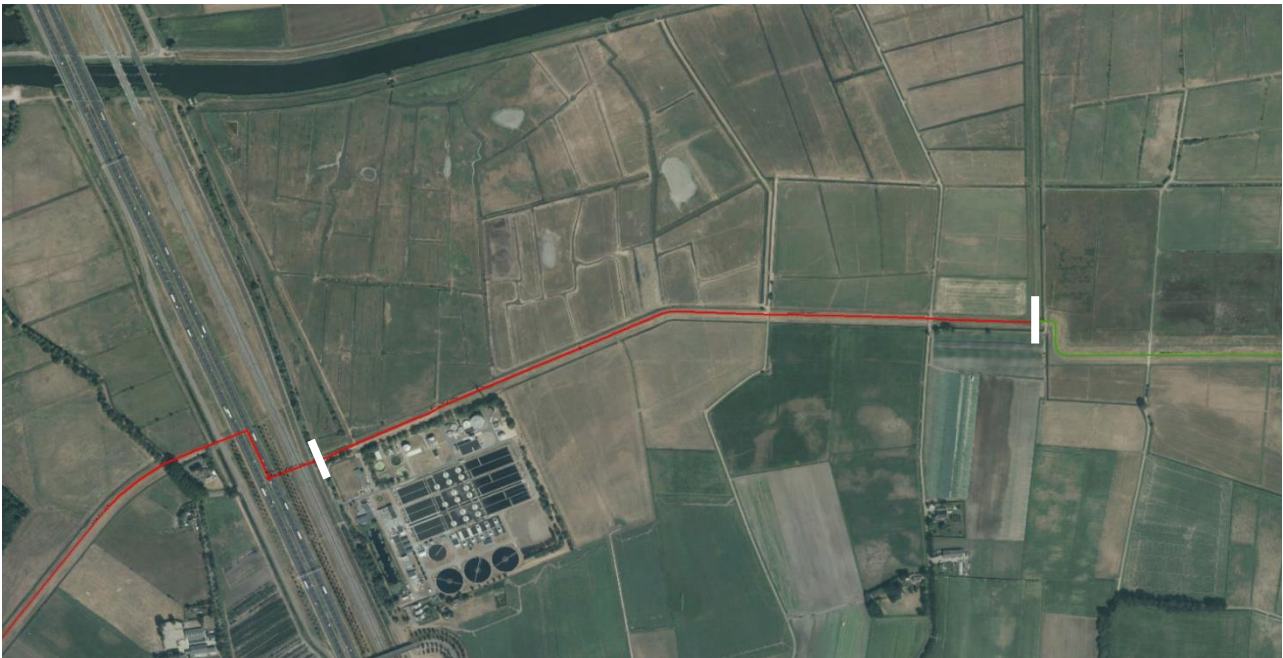
Figuur 12 Bovenaanzicht deelgebied, met linksonder de RWZI. De rode lijn tussen de witte markeringen, is de afgekeurde strekking
